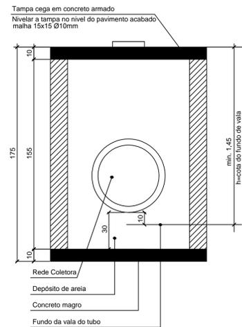
**DETALHE CAIXA DE CAPTAÇÃO SINFONADA
