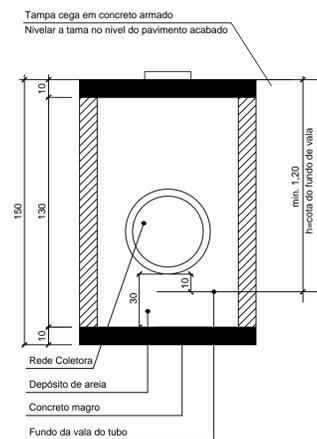
**DETALHE CAIXA DE CAPTAÇÃO SIFONADA PARA TUBOS DE Ø50cm**
